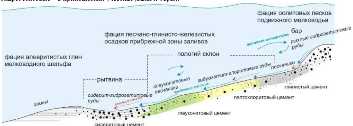
Рис. 2. Схематическая модель смены осадков по фациальному профилю (в направлении углубления моря) Западно-Сибирского железорудного бассейна
