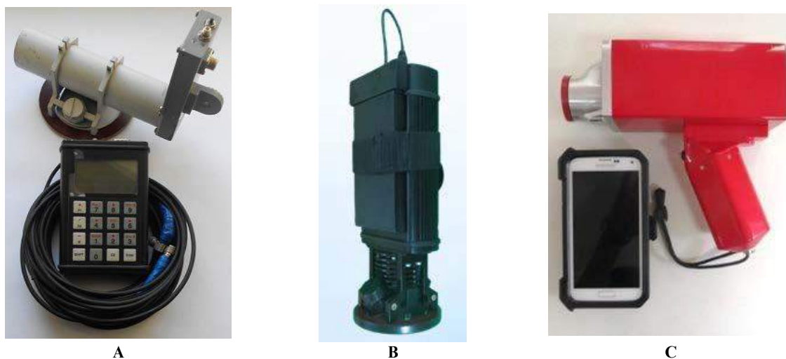
А В С Рис. 1. Линейка полевых спектрометров РПП-12 (А – базовый вариант, В – SDD/радионуклид, С – SDD/PT)
