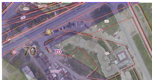
а) Охранная зона «Двухцепная» высоковольтная линия – 110кВ, ул. Беринга
