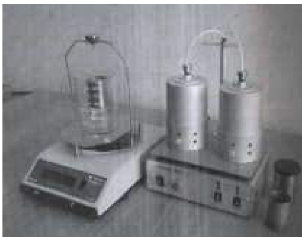
Рис. Аппаратура для определения плотности и пористости образцов
