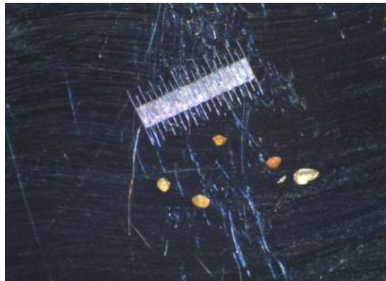
Рис. 1. Фотография монацита под оптическим микроскопом, длина линейки 1мм
