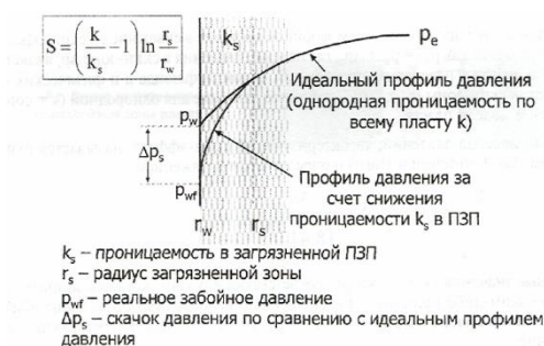
Рис.2 Аналитическое определение скин - фактора
