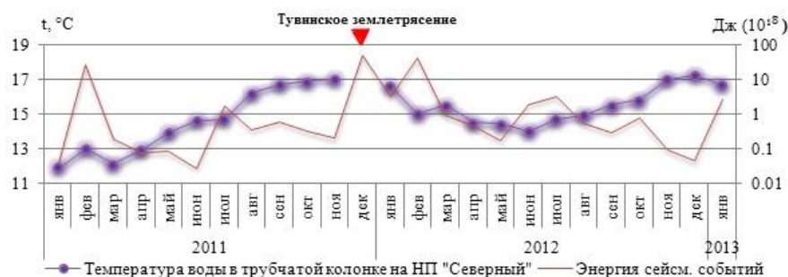
Рис.1 Взаимосвязь среднемесячной температуры подземных вод на НП. «Северный» в г. Горно-Алтайске с энергией сейсмических событий в АСР в 2011 – 2013 гг. (январь)
