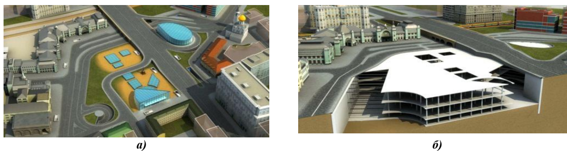
Рис. 1. Возможности 3D кадастра при регистрации: а) вид участка на поверхности; б) вид участка в разрезе 2
