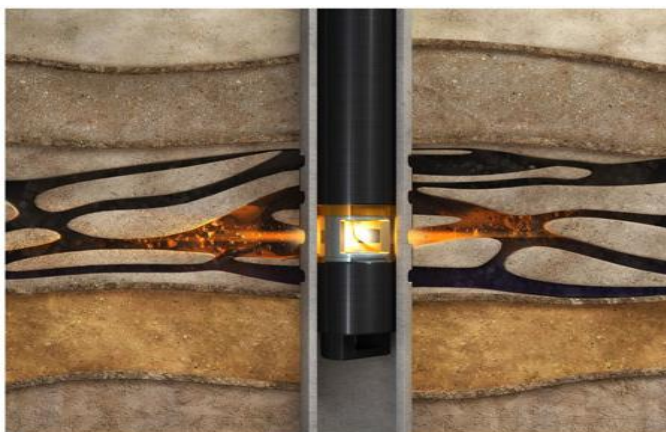
Рис. Плазменно-импульсное воздействие на пласт в скважине
