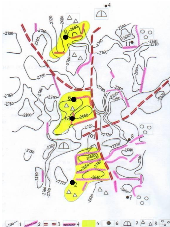
Рис. 2. Обзорная схема Малоичского месторождения (с учетом результатов трехмерной сейсморазведки)
