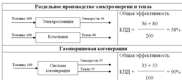
Рис. 2 Раздельное производство электроэнергии и тепла
