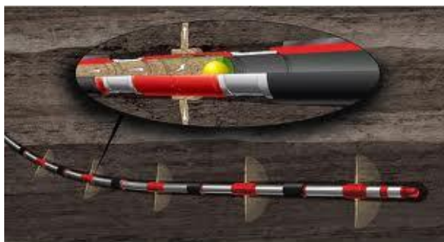
Рис. 1 Многостадийный ГРП в горизонтальной скважине
