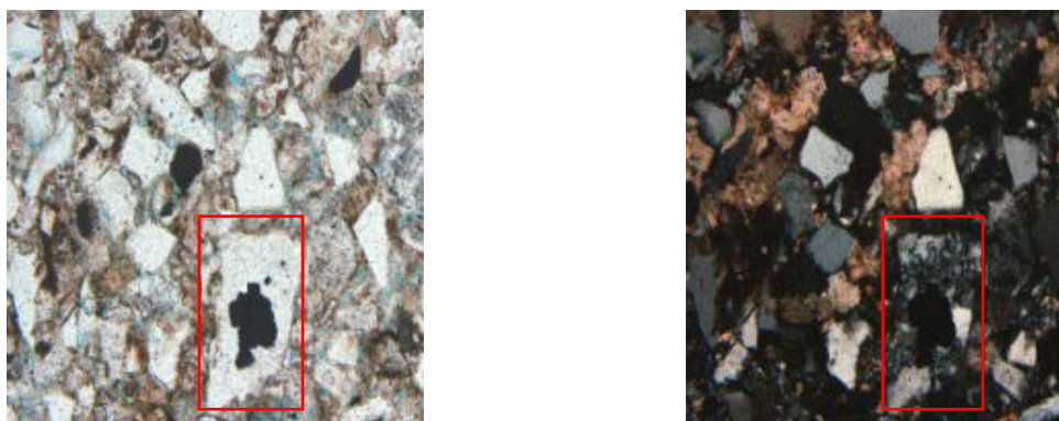
Рис. 2. Фотоснимок шлифа 2, скв. 4х06 Фаинского месторождения, пласт ЮС 1 , глубина по ГИС 3х22,89 м (увеличение 45х, николи параллельны и скрещены). Включения аутигенного пирита в обломках
