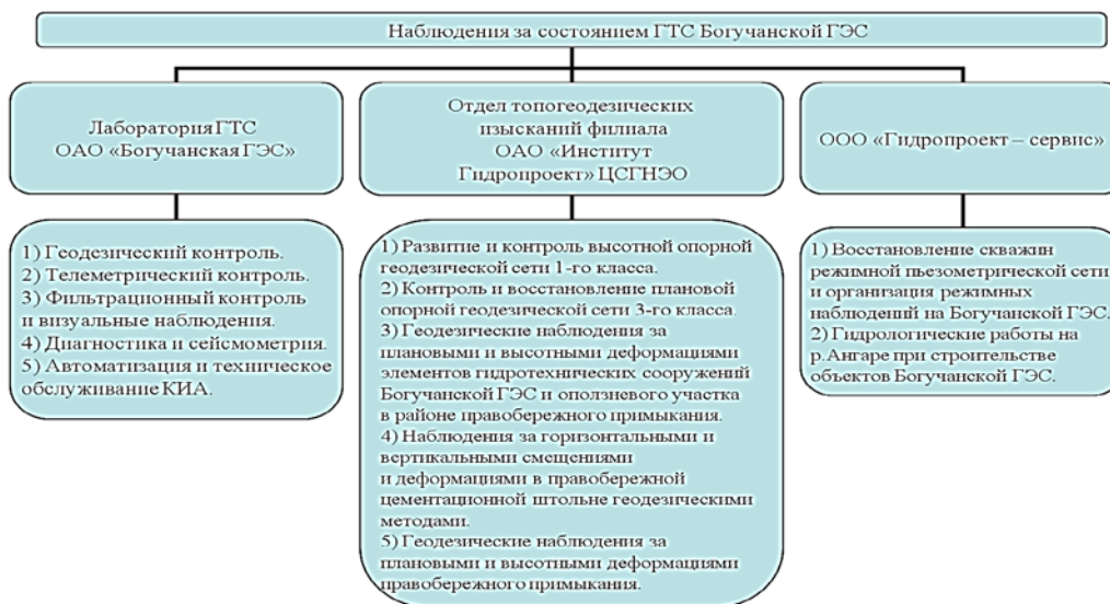
Рис. 1. Схема мониторинга за состоянием ГТС Богучанской ГЭС
