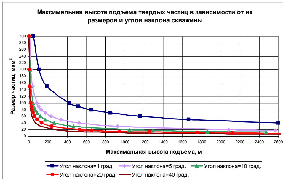
Рис. 1. Зависимость высоты подъема частицы от ее размера и угла наклона скважины
