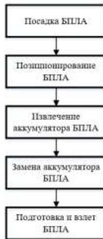
Рис. 2. Этапы обслуживания БПЛА при замене аккумулятора
