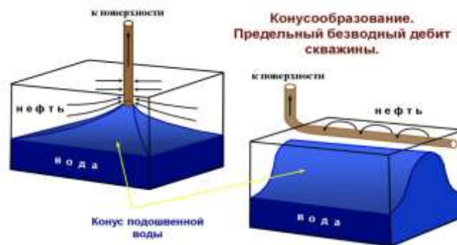
Рис. 1. Иллюстрация процесса конусообразования для вертикальной и горизонтальной скважины
