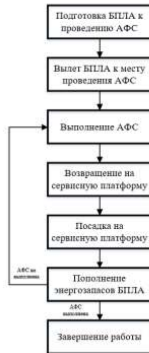
Рис. 1. Алгоритм взаимодействия БПЛА с сервисной платформой
