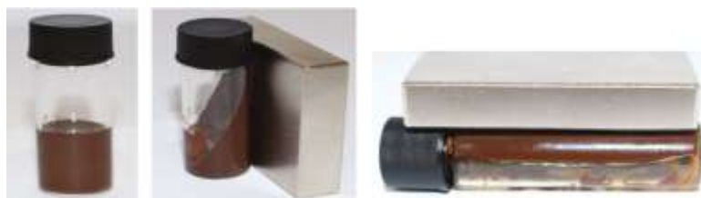
Рис. 2. Влияние магнитного поля на эмульсию [3]
