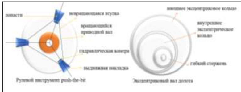
Рис. 1. Узел отклонения push-the-bit (а) и point-the-bit (б)
