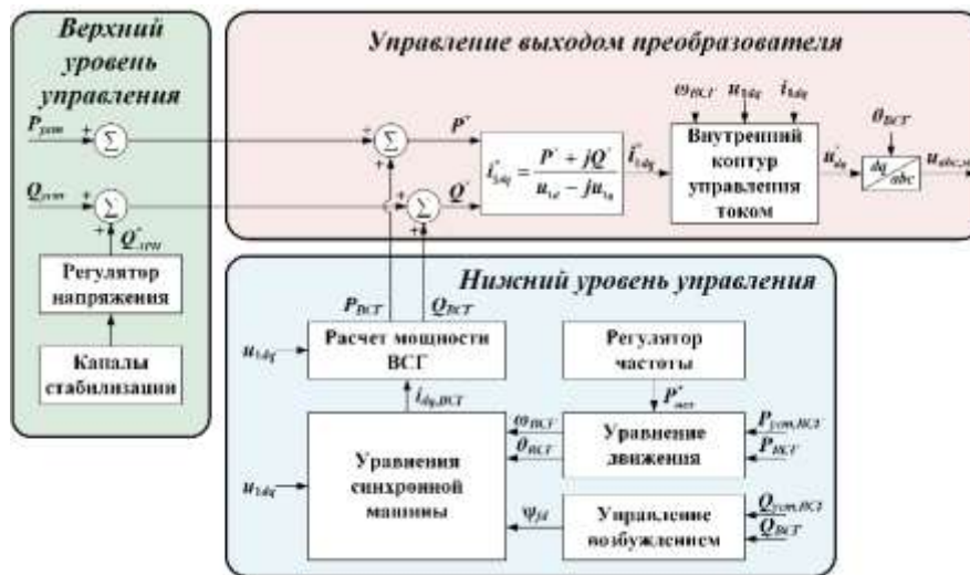
Рис. 1. САУ СП на основе ВСГ с параллельной структурой
