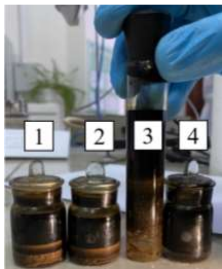
Рис.2. Результаты опыта с нефтью Столбового месторождения: 1 – холодное отстаивание; 2 – схема постоянный магнит – нагрев – отстаивание; 3 – схема нагрев– постоянный магнит – отстаивание; 4 – химическая обработка
