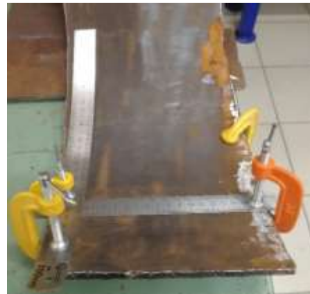
Рис. 2. Закрепление линеек на внутренней поверхности
