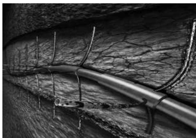
Рис.2. Скважина, оборудованная технологией fishbone
