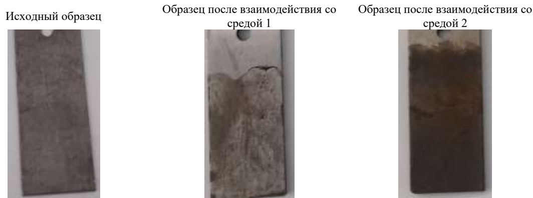
Рис. Примеры образцов углеродистой стали до и после испытаний
