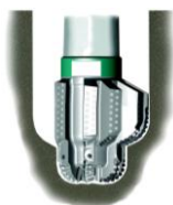
Рис.1. Увеличение диаметра дополнительного ствола бицентричным долотом
