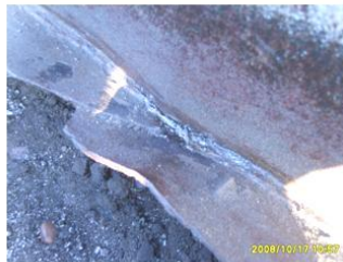
Повреждение резервуара РВС-700 №9 нефтебазы с. Хонуу ГУП «ЖКХ РС(Я)»
