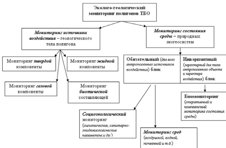
Рис. Схема соподчинения отдельных методов мониторинга комплексного ЭГМ полигонов ТБО и др. антропогенных объектов
