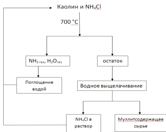
Рис. 3 Блок-схема хлораммонийной способа переработки каолинита
