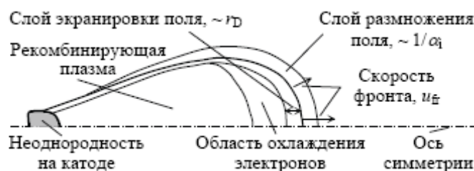
Рис. 1. Качественный вид разряда на основе волны размножения фона
