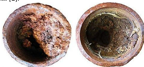
Рисунок. Выпадение асфальтосмолопарафиновых отложений в насосно-компрессорных трубах
