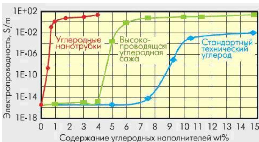
Рис. 2. Зависимость электропроводности от содержания углеродных наполнителей: углеродных нанотрубок, высокопроводящей углеродной сажи, стандартного технического углерода
