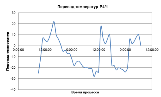
Рис. Перепад температур в реакторе Р4/1
