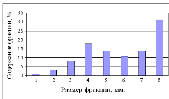
Рис. 1 Гранулометрический состав образца руды 1 - < 0,25 мм.; 2 - 0,25 – 0,5 мм.; 3 - 0,5 – 1 мм.; 4 - 1 – 2 мм.; 5 - 2 – 3 мм.; 6 - 3 – 5 мм.; 7 - 5 – 7 мм.; 8 - > 7 мм.
