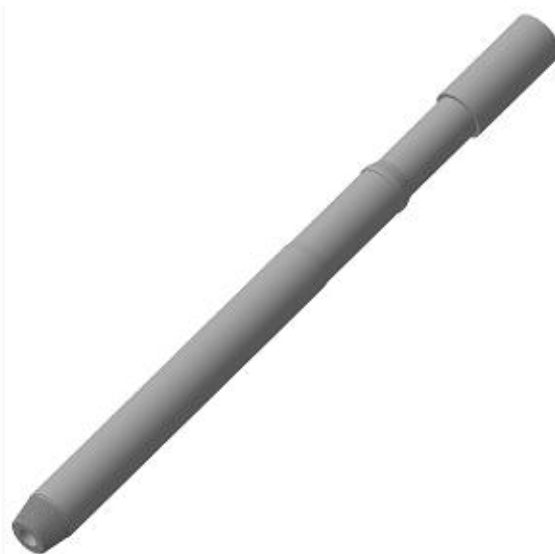
Рис. 3. 3D-модель УБТ типа Б
