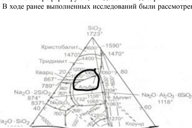
Рис. 4 Область исследуемых составов композиций «диатомит-вермикулит» на диаграмме состояния системы Na_2O - Al_2O_3 - SiO_2
