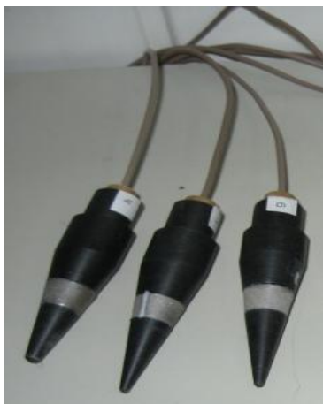
Рис. 1. Пилотная партия сухих безэлектролитных электродов сравнения
