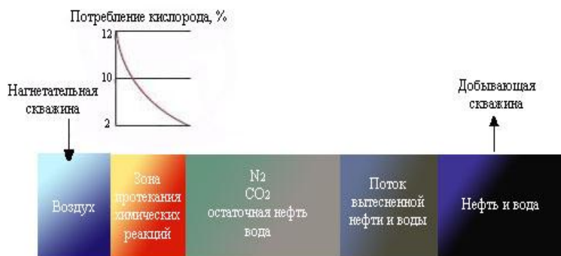
Рисунок. Схема термогазового воздействия на пласт [4]
