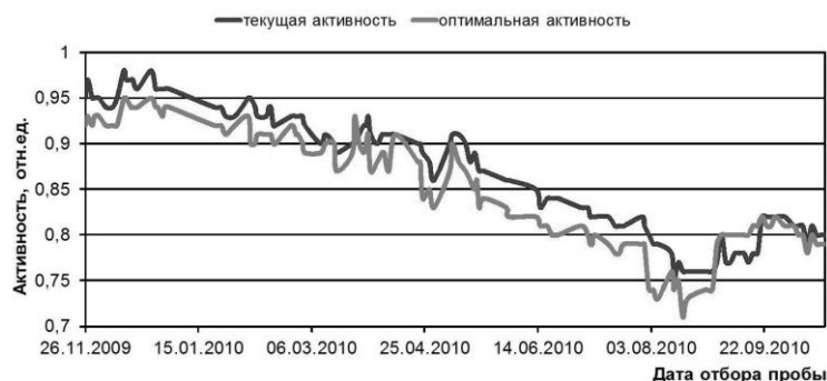
Рис. Сравнение текущей и оптимальной активности катализатора установки ЛЧ-35-11/1000
