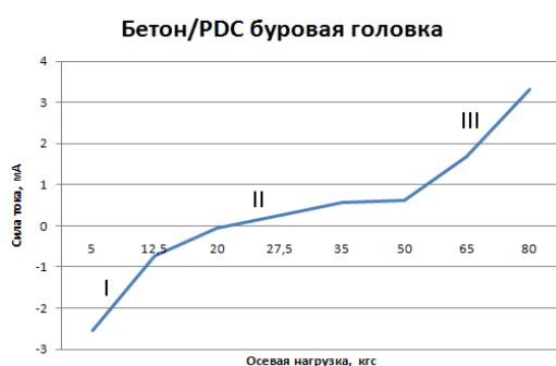
Рис. 3. Зависимость силы генерируемого при разрушении образца тока от осевой нагрузки при использовании буровой головки с режущими PDC
