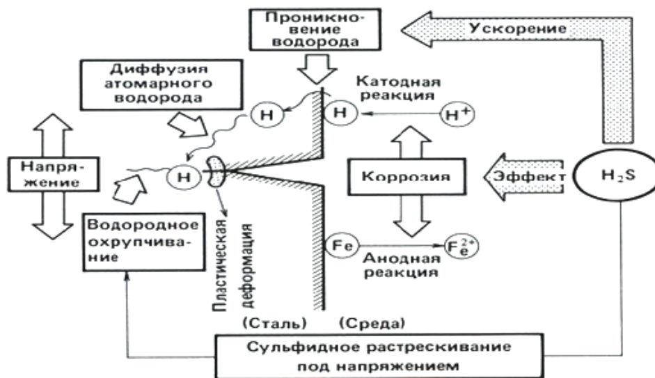
Рис.1 Схема процесса ВКР
