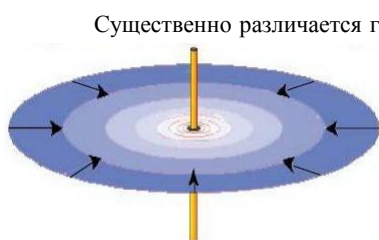
Рис. 1. Приток к наклонно-направленной скважине
