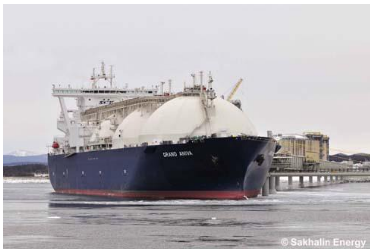
Рис. 2 Танкер-газовоз «Гранд Анива» у причала отгрузки СПГ завода по производству СПГ в Пригородном, февраль 2009 г. (фото компания «Сахалинская Энерджи»)
