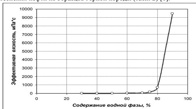
Рис. Зависимость эффективной вязкости ГЭС от содержания водной фазы при скорости сдвига 25 \text{ с}^{-1} при 80 \text{ }^\circ\text{C}
