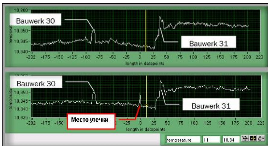
Рис. 2. Профиль температуры, измеренный до возникновения утечки и после, на расстоянии 17 970 м от станции закачки в трубопровод солевого раствора. Вертикальная шкала соответствует частоте Бриллюэновского сдвига в ГГц. Обнаруженное системой мониторинга локальное повышение температуры (около 8 °C) соответствует месту утечки солевого раствора в трубопроводе
