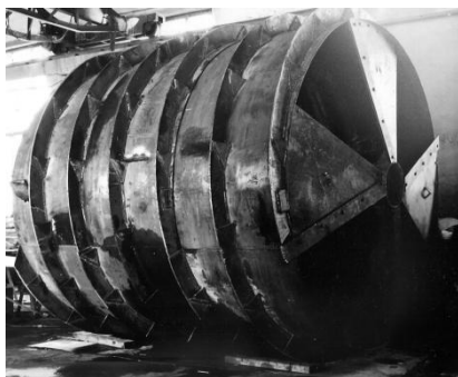
Рис.1 Экспериментальный образец геохода ЭЛАНГ-3 диаметром 3 м
