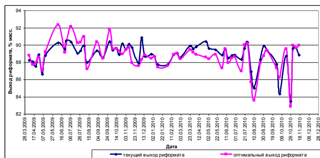
Рис. 2. Выход стабильного катализатора при работе установки на текущей и оптимальной активности катализатор
