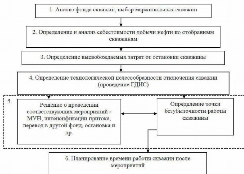
Рис. Алгоритм принятия решений о целесообразности эксплуатации скважин
