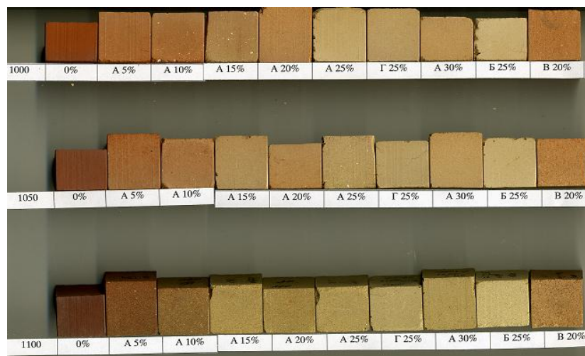
Рис.1 Изменение цветowych характеристик в зависимости от количества добавки
