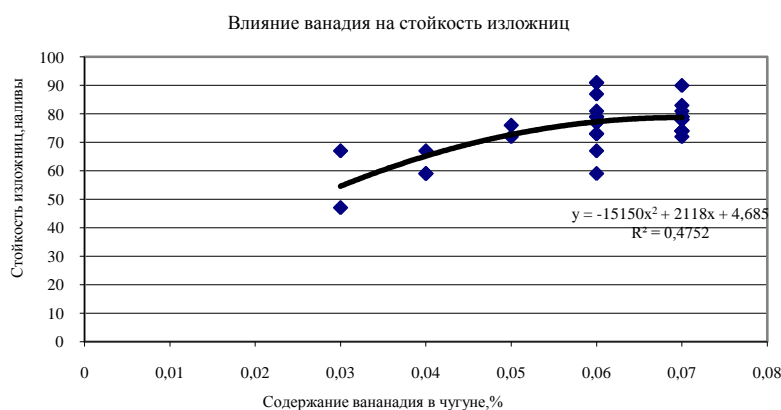
Рис. Зависимость термостойкости изложниц от содержания ванадия в чугуна
