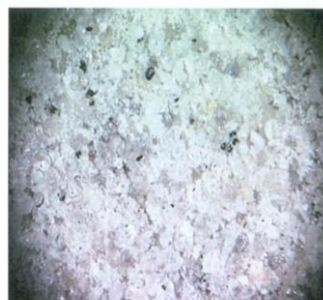
Рис. 2. Оптическое исследование песка из карьера «Каменский» при давлении 80 МПа Средний размер зерен 0,238 мм
