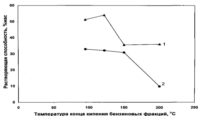
Рис. 1. Зависимость растворяющей способности узких бензиновых фракций по отношению к АСПО 2-х видов от температуры конца кипения фракции;
