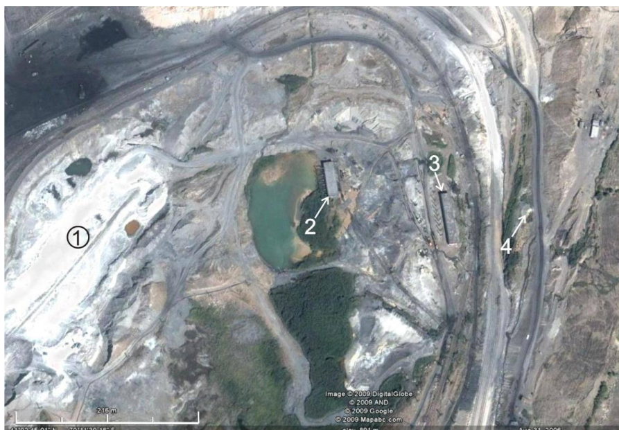
Рис. 1. Карьер первичных каолинов (северо-восточная часть разреза «Ангренский»). 1 – карьер, 2 – насосная, 3 – электроподстанция, 4 – место отбора технологической пробы
