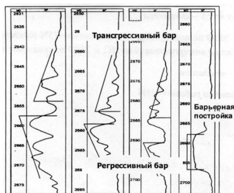
Рис. 2. Электрометрическая характеристика мелководных песчано-алевритовых построек [2]
