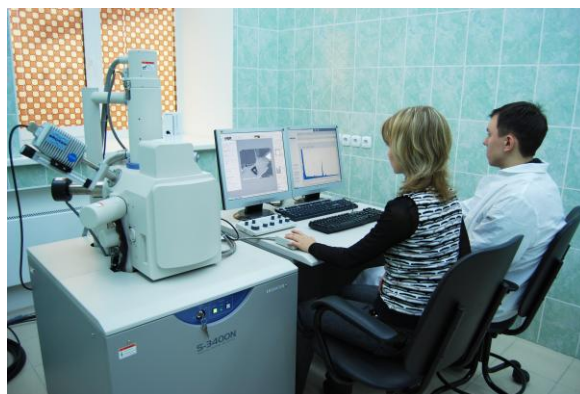
Фото 6. Научные исследования ведут студенты в международном инновационном-научно-образовательном центре «Урановая геология» ИПР ТПУ на сканирующем электронном микроскопе HitachiS-3400N с приставкой для микроанализа
