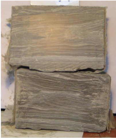
Рис. 2. Поперечный разрез монолита вендской глины
