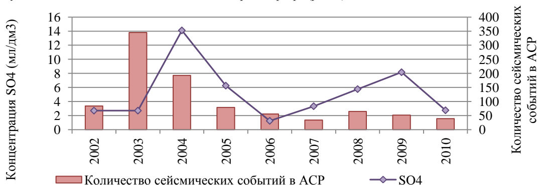
Рис. 2 Динамика концентраций сульфатов и связь ее с сейсмическими событиями на водозаборной скважине С24/91, в с. Мараловодка
