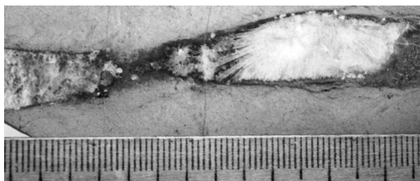
Рис. 2. Радиально-лучистое строение кальцита в глинистом известняке, продольное сечение секретии
