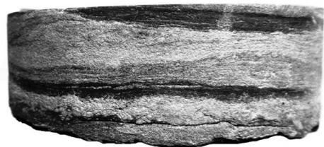
Рис. 1. Фотография образца алевропесчаника с глинистыми прослоями
