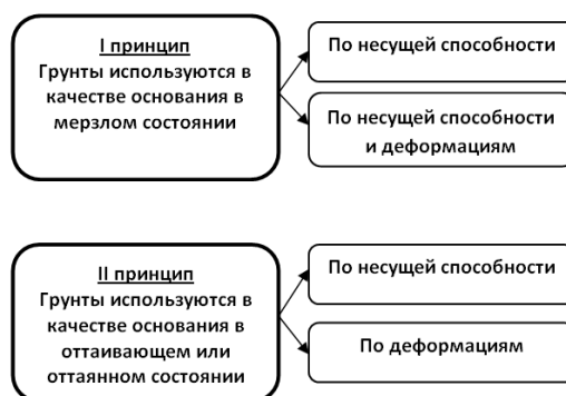
Рис. Схема расчетов оснований в районах развития криолитозоны
