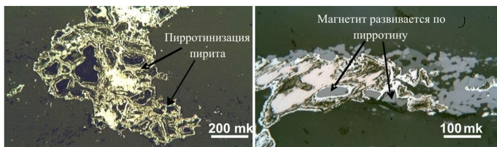
Рис. 1. Последовательность минералообразования во вмещающих породах (пирит → пирротин → магнетит). Без анализатора
