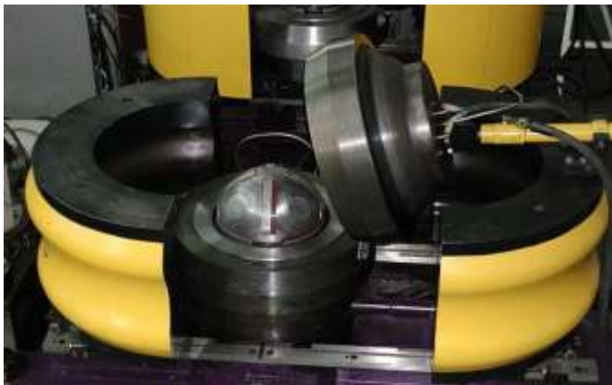
Рис. 2. Оборудование для создания искусственных алмазов [3]
