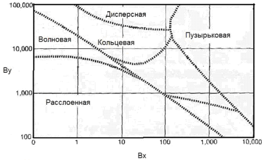
Рис.2. График определения структуры потока
