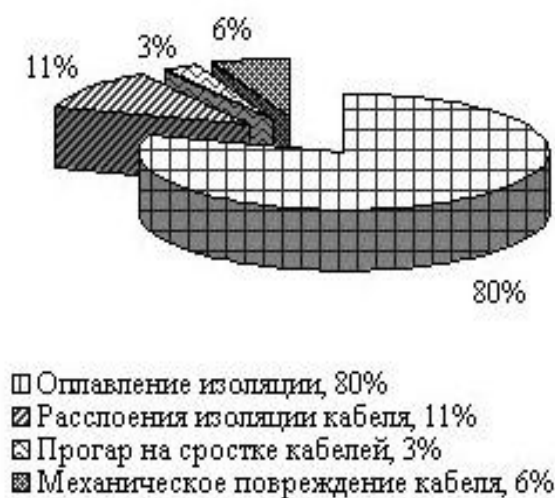
Рис. 2. Распределение причин отказов кабельных линий
