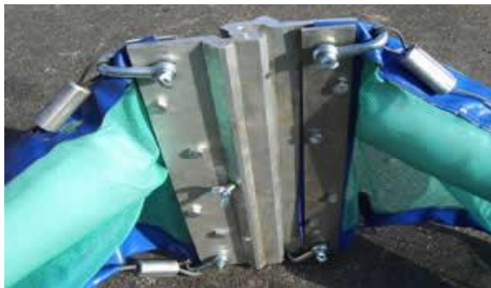
Рис. 1. Соединительный элемент бонового ограждения
