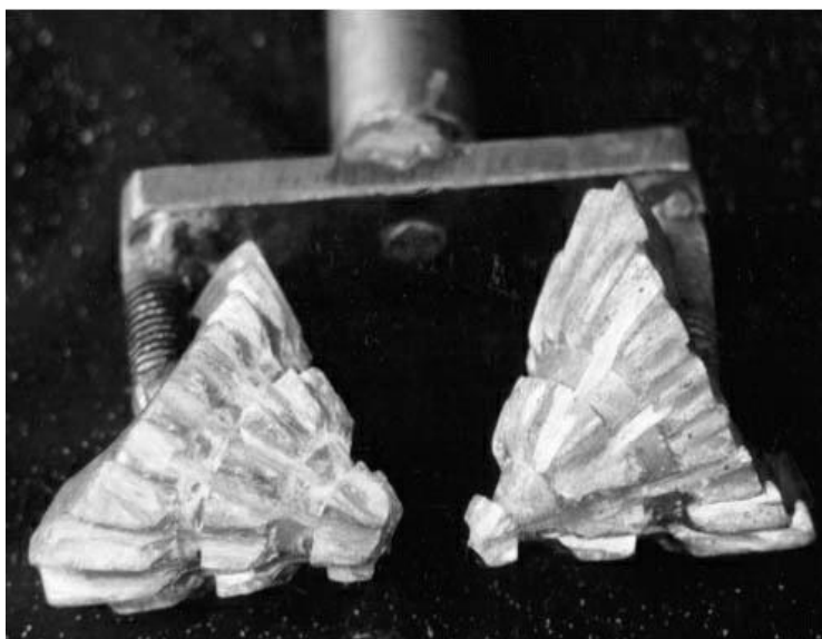
Рис. 1. Опытный образец шарошечного долота для бурения скважины с квадратным поперечным сечением
