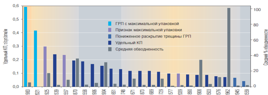
Рис. 2 Сравнительный анализ величины нормализованного КП как функции поведения эффективного давления в процессе ГРП
