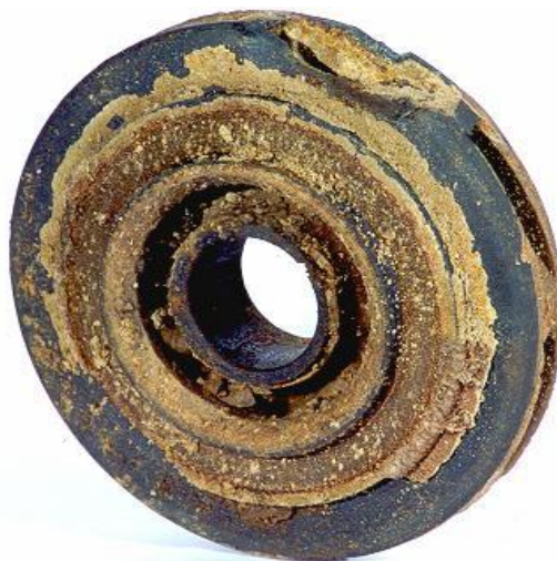
Рис. 1 Многочисленные изъявления и коррозия, вызванные скоплением солеотложений
