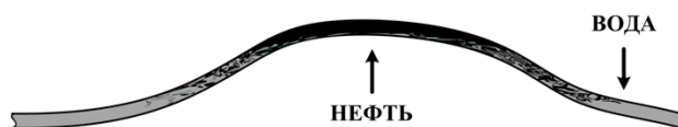
Рисунок 5. Нефте-водяная стратификация при остановке потока в трубопроводе, проложенного через холм. Вязкая нефть ( \rho_{\text{нефти}} < \rho_{\text{воды}} ) поднимается вверх и может полностью блокировать трубопровод.
