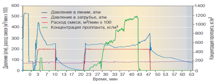
Рис. 3 Результаты обработки скважины 1981 на месторождении Сугмутское. Закачка пропанта на завершающей стадии приводит к увеличению давления, указывая на наличие эффекта образования повышенной упаковки пропанта
