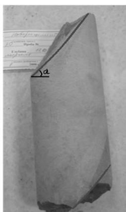
СКВ. 50 глубина 17м \alpha = 53^\circ - 58^\circ \varphi = 16^\circ - 26^\circ
