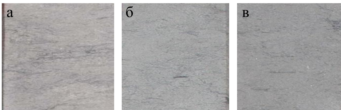
Рис. 2. Песчаник тонко-мелкозернистый с частыми глинисто-алевритовыми слойками интенсивно биотурбированный. Фация переходной зоны пляжа. Пласт Ю 1 1-2 . а – скв. 345, гл. 2699,2 м; б – скв. 1, гл. 2727 м; в – скв. 2, гл. 2666 м
