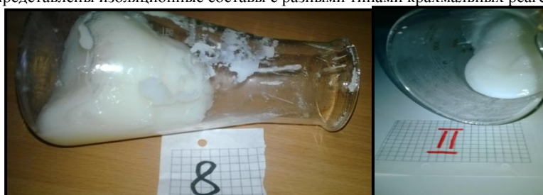
Рис 1 – Визуальное сравнение составов изоляционного веществ с двумя различными марками крахмала
