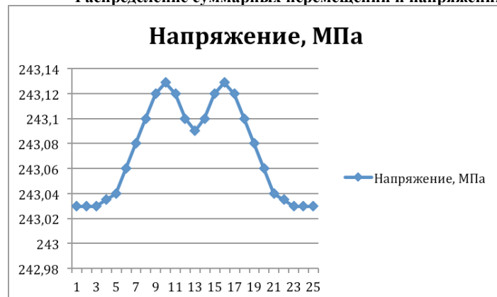
Рис 1. График изменения напряжений по длине трубопровода
