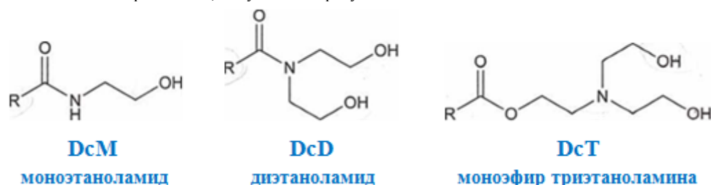
Рис.1 Условные формулы эмульгаторов (R - остаток жирной или смоляной кислоты таллового масла)
