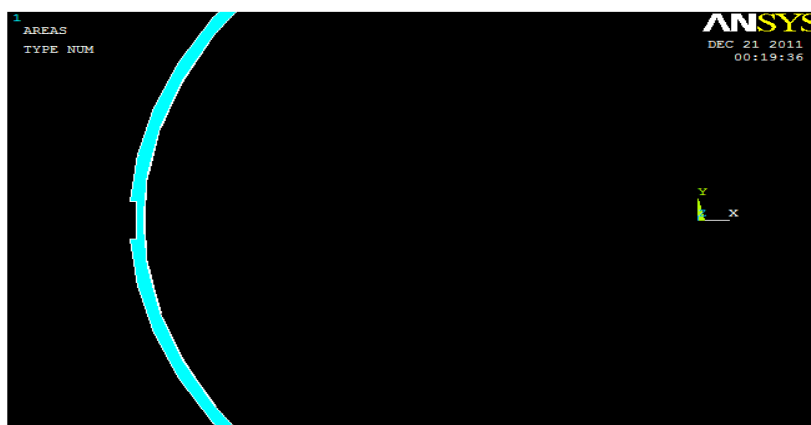
Рис.2 Дефект трубопровода со сплошной коррозией
