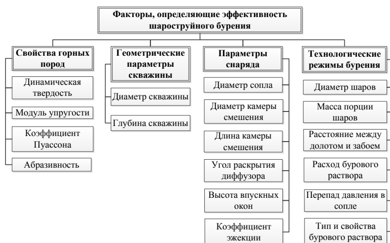
Рис. 1. Классификация факторов, определяющих эффективность шароструйного бурения
