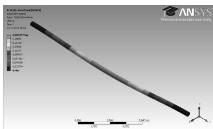
Рис. 5 Деформации, возникающие в газопроводе при осадке грунта
