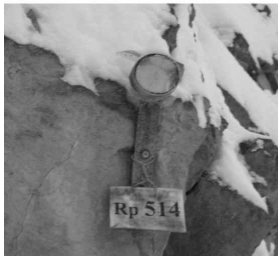
Рис. 2 Рабочий репер настенного типа
