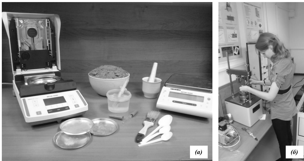
Рис.2 Приборы и оборудование для подготовки грунта (а); проведение компрессионных испытаний песчаного грунта (б)
