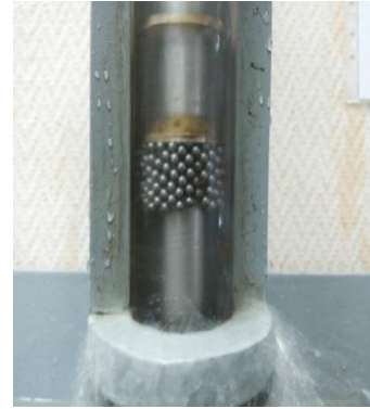
Рис. 6. Заклинивание шаров в затрубном пространстве
