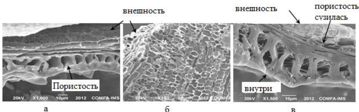
Рис. 3 Структура золы после сжигания при температуре 850 °C а - поверхность золы огрубела из-за перегрева; б - головка отделившегося диоксида кремния; в - пористость полученного угля снизилась
