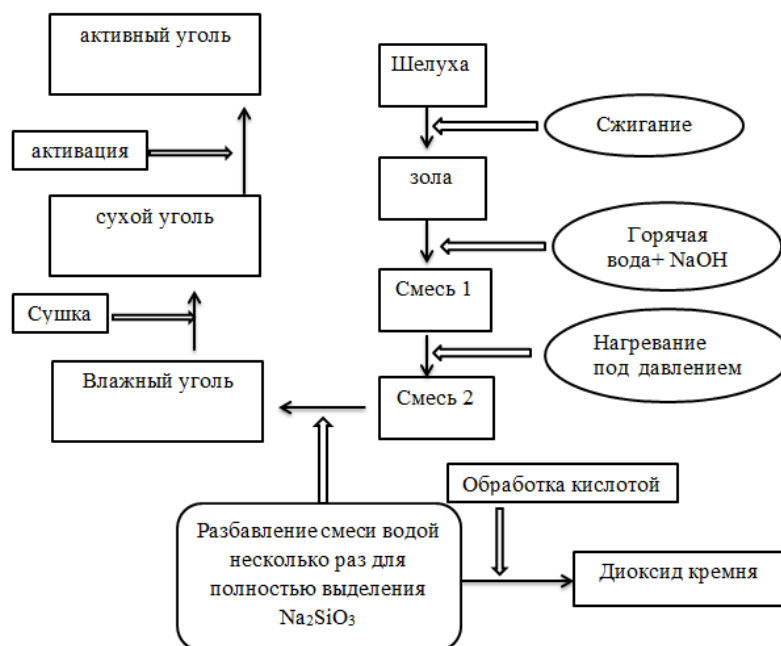
Рис. 1 Технологическая схема процессов переработки рисовой шелухи с получением активного угля и диоксида кремния
