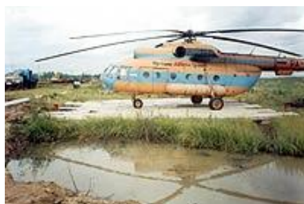
Рис. МИ-8 на площадке из ПДПУ [3]
