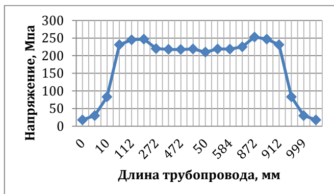
Рис. 2 График изменения напряжений по длине трубопровода
