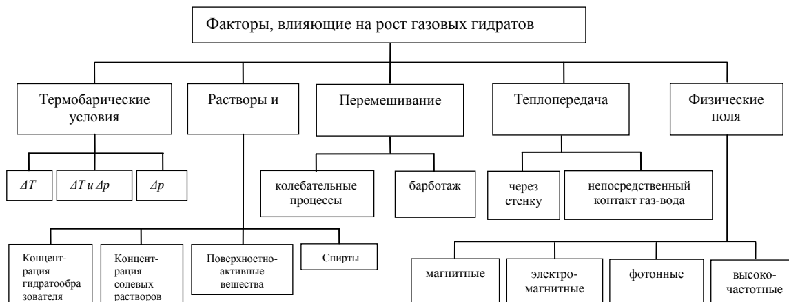
Рис. Классификация факторов, влияющих на рост гидратов природных и нефтяных газов
