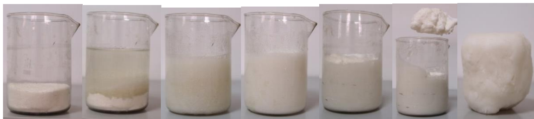
Рис. 3. Поэтапное затворение изолирующего вещества
