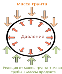
Рис. 1 Нагрузки, действующие на стенку трубопровода
