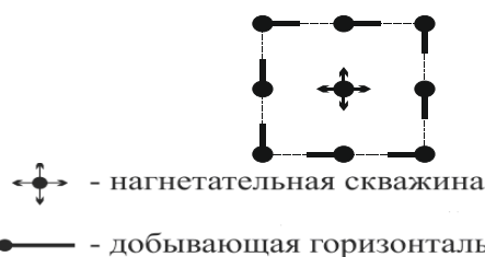
Рис.4 Девятиточечные системы заводнения с использованием горизонтальных скважин
