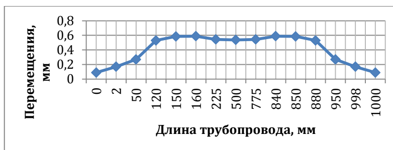
Рис. 3 Суммарные перемещения трубопровода
