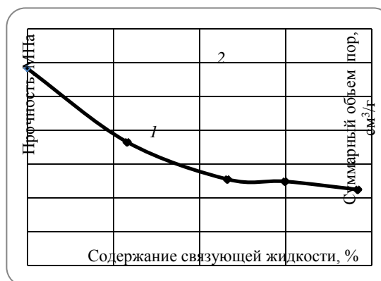
Рис. 2 Зависимость прочности (1) и суммарного объема пор (2) таблеток от содержания глицерина
