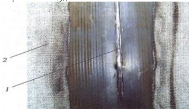
Рис.1. Корневой шов, выполненный процессом STT 1 — шов; 2 — термозащитный пояс.
