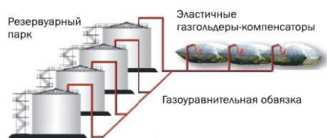
Рис. 3. Система рекуперации паров легких фракций углеводородов
