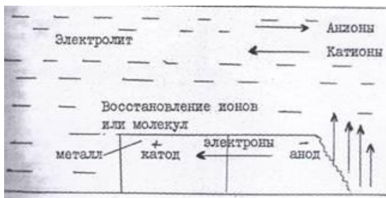
Рис.1 Процесс коррозионного разрушения металла
