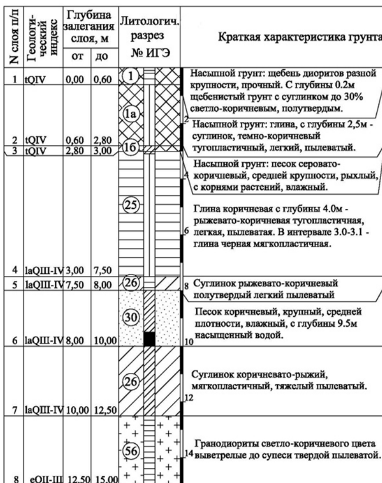
Рис.1. Типовой литологический разрез технологической скважины (на примере скважины №2)
