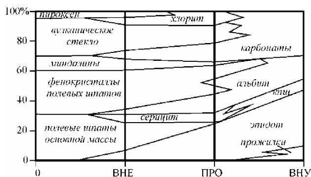
Рис. 2. Диаграмма минералогического преобразования андезито-базальтов при пропилитизации на Боко-Васильевском месторождении. Метасоматические зоны: 0 – неизменные породы, ВНЕ – внешняя зона, ПРО – промежуточная зона, ВНУ – внутренняя зона
