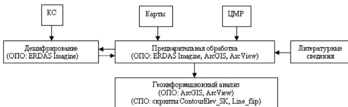
Рис. Схема анализа данных для оценки влияния нефтеразливов на состояние окружающей природной среды. ЦМР - цифровая модель рельефа, ОПО – общее программное обеспечение, СПО – специальное программное обеспечение
