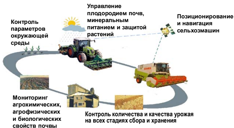
Рис. Основные элементы системы точного земледелия (по Р.И. Афанасьеву)
