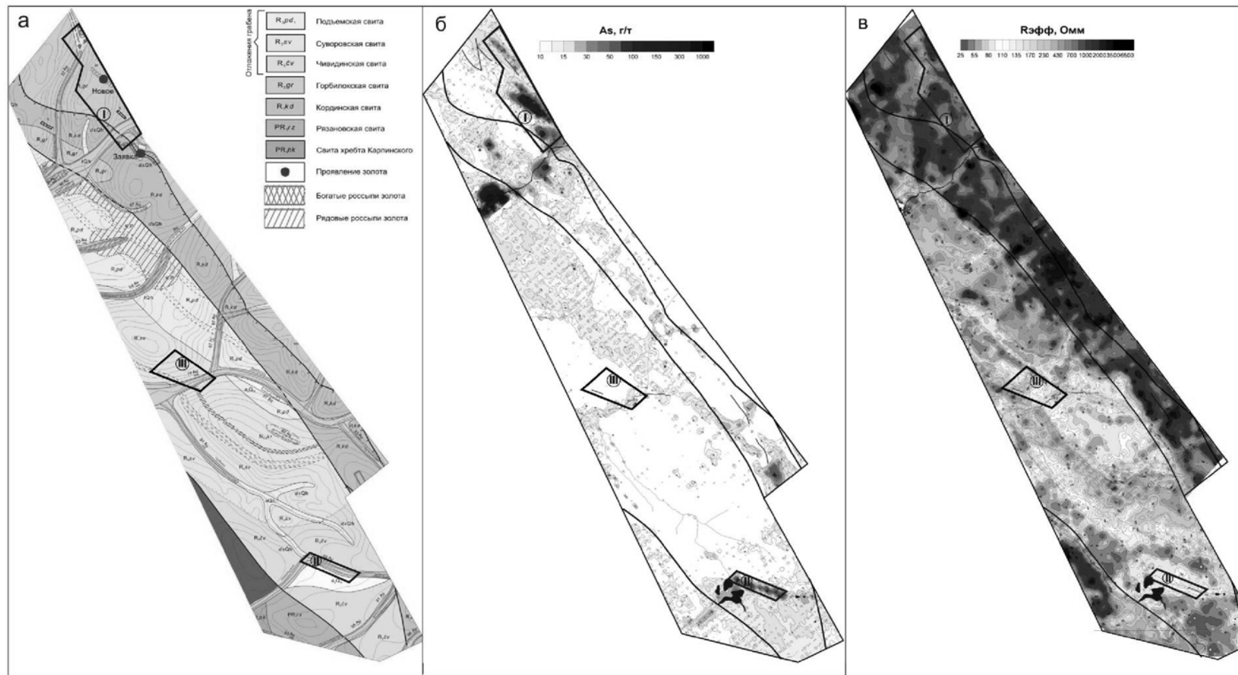
Рисунок. Распределение мышьяка и эффективных сопротивлений на Дюбкошской площади: а – геологическая карта; б – карта геохимического поля мышьяка; в – карта эффективности электрического сопротивления
