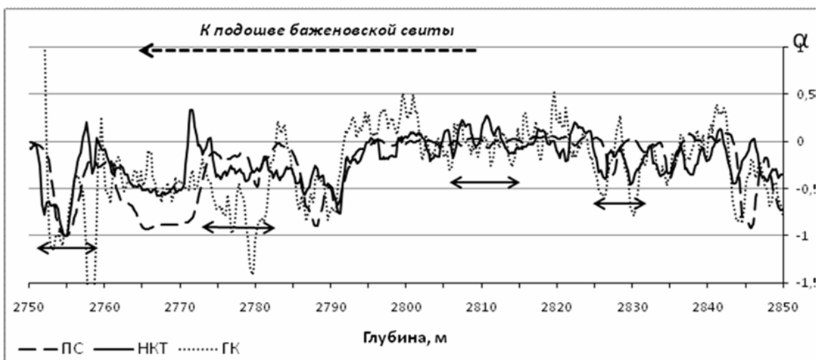
Рис. 1. Интервалы карбонатизации пород васюганской свиты (стрелки сплошной линией) по результатам интерпретации геофизических исследований скважины. Приведены нормированные значения показаний ГИС. Значения НКТ умножены на -1
