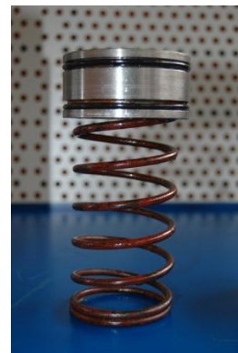
Рис. 3. Поршень компенсатора с двойным уплотнением из эластомера полиуретана
