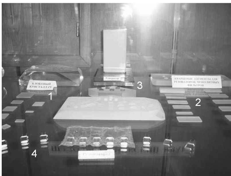
Рис. 1. Изделия из пьезокварца: 1 – искусственный кристалл кварца, 2 – кварцевые элементы для резонаторов и фильтров, 3 – генератор ультразвуковых колебаний, 4 – кварцевые резонаторы.
