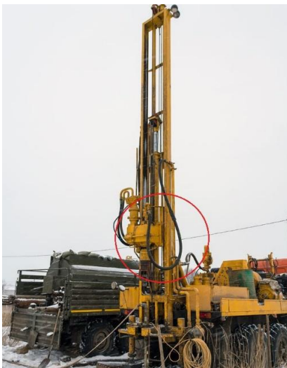
Рис.1. Особенности бурения скважин в зимних условиях. На фото выделено наиболее уязвимое место изгиба РВД гидросистемы УРБ при спуско-подъемных операциях
