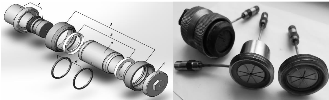
Рис. 1 Общий вид камеры: 1 – обойма и пневмоцилиндр с манжетой; 2 – шайбы; 3 – второпластовые прокладки; 4 – корпус; 5 – крышка; 6 – стопорные кольца
