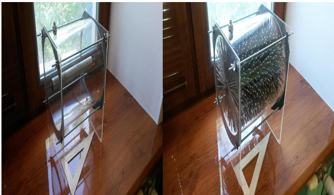
Рис. 1 Гладкотрубный и игольчатооребрённый экспериментальные теплообменники.
