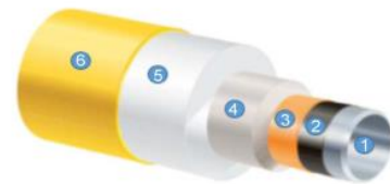
Рис. 2 Схема трубопровода с многослойным покрытием
