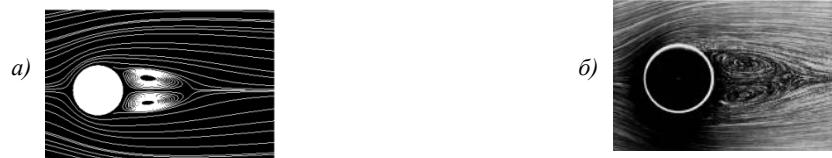
Рис. 2 Изменение линий тока при Re = 26 (а), картина течения в области кругового цилиндра при 10 < Re < 40 (б) [4]
