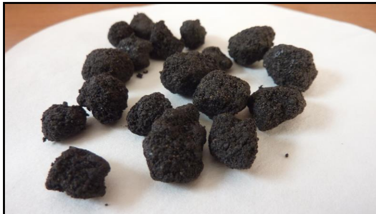
Рис. 1 Гранулы из смеси на основе золы, серы и битумной эмульсии
