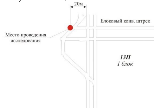
Рис. 1 Схема расположения места проведения исследований для определения газоносности пород пласта АБ в блоковом конвейерном штреке 13 восточной панели.
