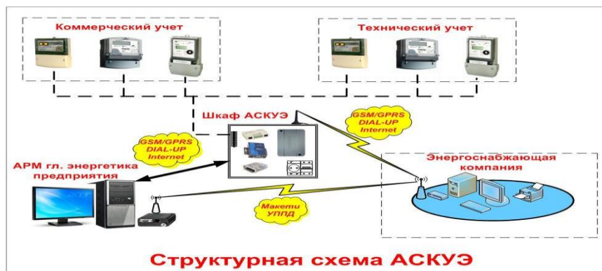
Рис.3. Структурная схема АСКУЭ
