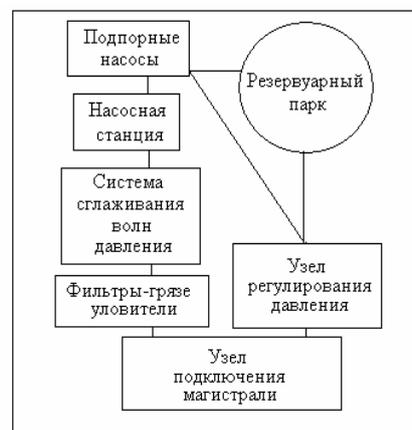
Рис. 1. Технологическая схема основного оборудования НПС
