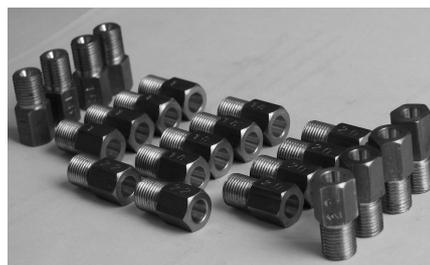
**Рис. 2. Комплект разработанных гидродинамических насадок и генераторов кавитации**
