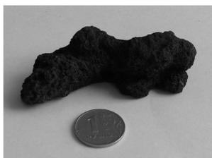
**Рис. 1. Фрагмент отложения, удаленный из полости охлаждения силовой втулки**
