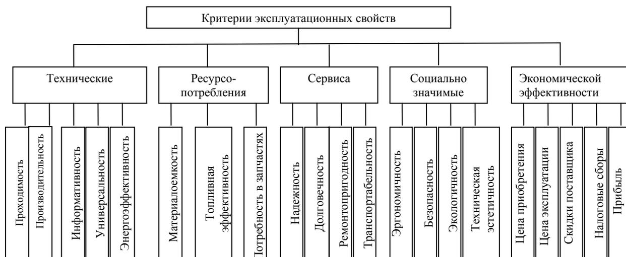
**Рис. Классификация критериев эксплуатации машин и оборудования для строительства и ремонта магистральных и промышленных трубопроводов**
