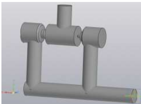
Рис. 1. CAD-модель гидравлического диспергатора ДГ-40
