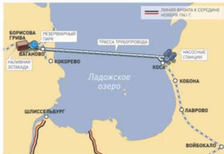
Рис. 1. Схема трубопровода через Ладожское озеро. 1942 год [2]
