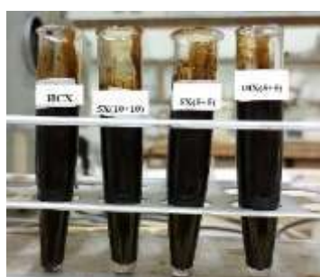
Рис. 1. Фотография эмульсий, термостатированных при 50 °С в течение 1 ч
