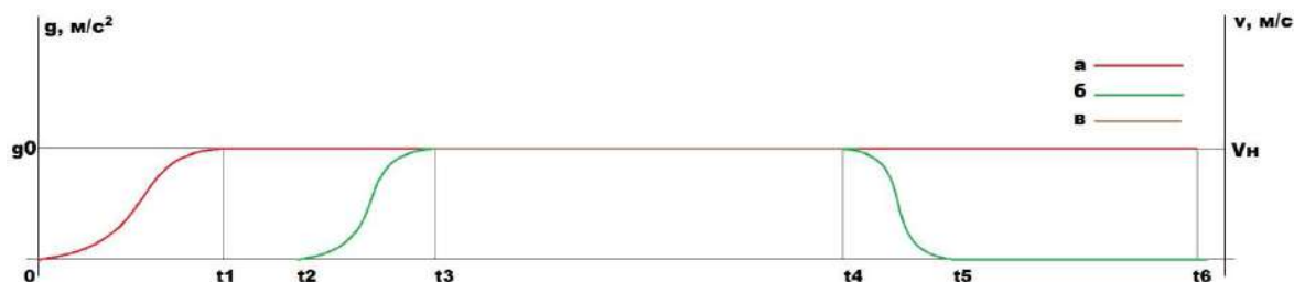
Рис.2. Процесс нагружения горного массива под действием силы тяжести и боковых смещений: а – задание ускорения свободного падения, б – зависимость нарастания и убывания скоростей на боковых границах, в – совместное действие скоростей и ускорения свободного падения.
