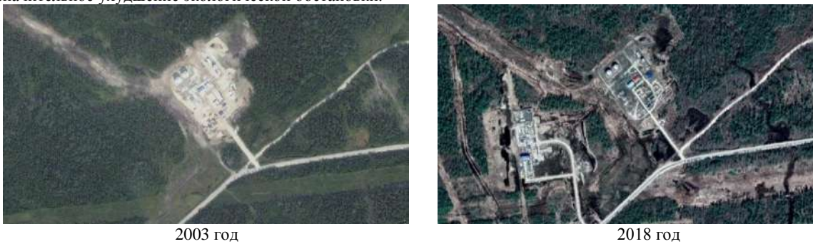
Рис. 2. Пример физической деградации земель при строительстве и эксплуатации объектов нефтегазового месторождения
