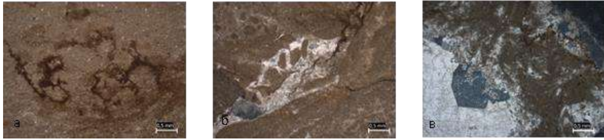
Рис. 1. Шлифы карбонатных пород (никколи +): а – битуминозные трещины в обломочном органогенно-детритовом известняке, б - руковообразная трещина, в – стиллолитовый шов
