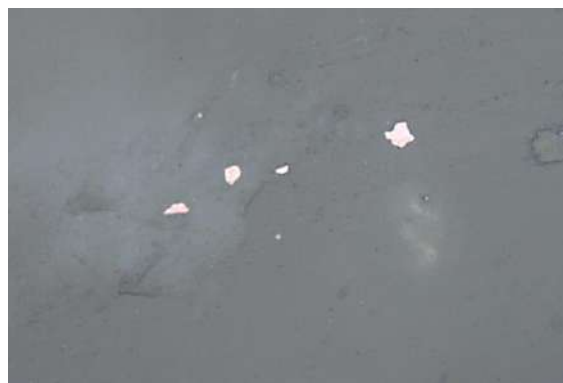
Рис. 2. Скопление микрозёрен (0,01...0,015 мм) самородной меди в кварце. Полированный шлиф
