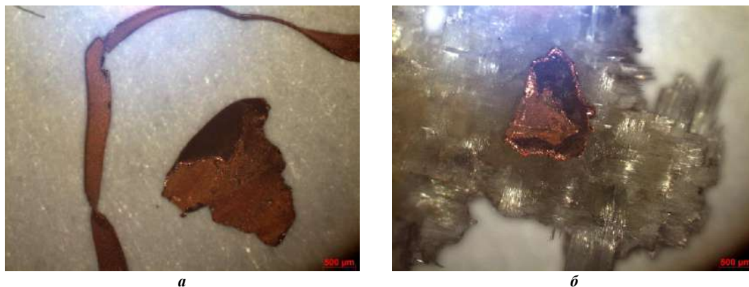
Рис. 2. Чистая медь (фракция - 0.5 мм (а)) и в сростании со стеклотекстолитом (фракция + 5 мм (б))
