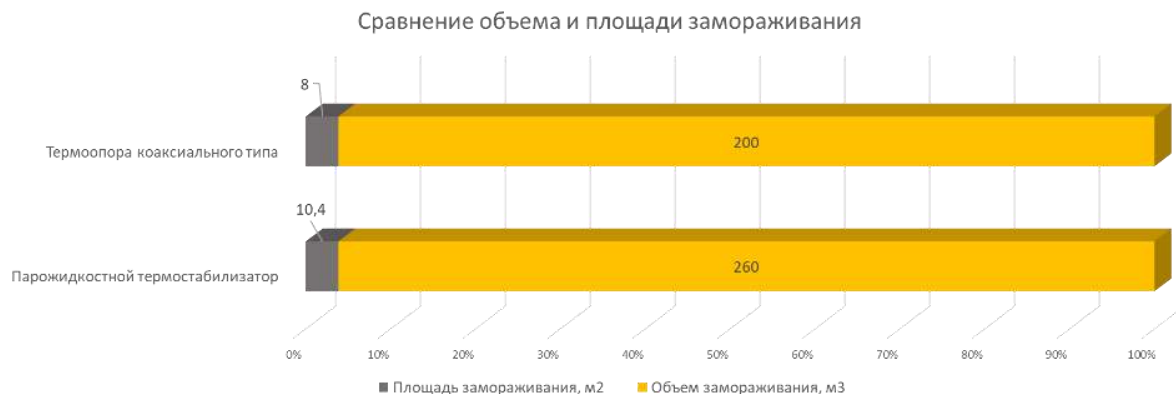
Рис. 1. Сравнение систем термостабилизации по объему и площади замораживания [1]
