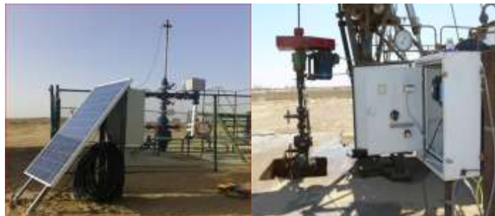
Рис. 1. Состав оборудования системы дистанционного контроля
