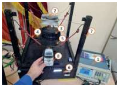
Рис. 1. Разработанный стенд для проведения вибрационных испытаний; (1 – генератор частот, 2 – кулер, 3 – низкочастотный вибрационный динамик, 4 – трос-демпфер, 5 – площадка фиксации образца, 6 – усилитель частот, 7 – стальная рама, 8 – виброметр ВК-5М).
