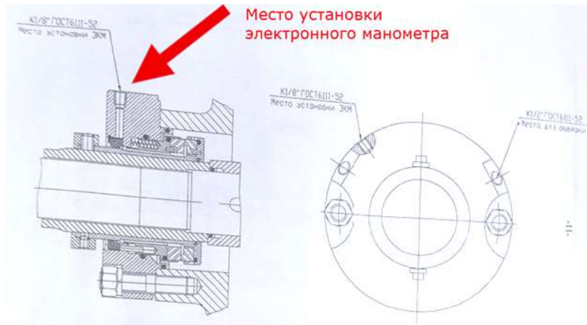
Рис. 4. Место установки электронно-контактного манометра
