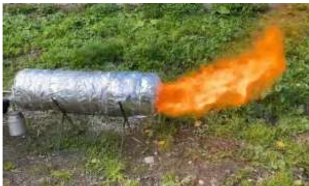
Рис. 1. Проведение полевых испытаний, фото горения суспензионного топлива
