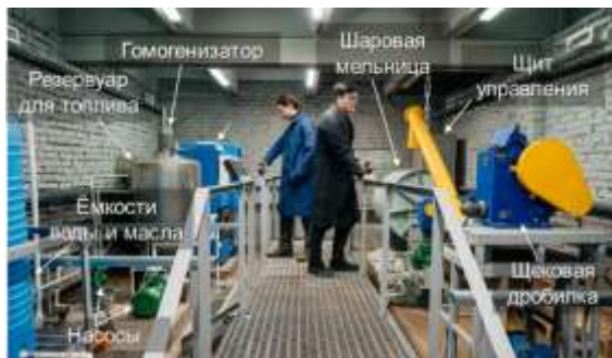
Рис. 2. Фото пилотной энергетической установки на реальном объекте
